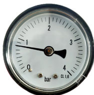
Figure 15 - Pression de référence Pr de 0.8 bar (0.8 Kg/cm 2 ) en début de fonctionnement du filtre.
