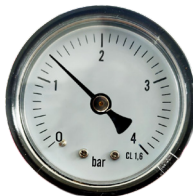
Figure 16 - Si la pression augmente de 0.3 à 0.5 bar par rapport à la pression de référence Pr : Entretien de la cartouche nécessaire
