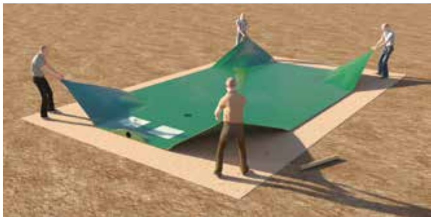
Schéma 8 - Création d'un coussin d'air
